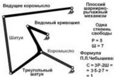
Кинематическая схема механизма «Велосипед» П.Л. Чебышева
